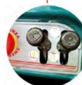
Un distributeur hydraulique par levier permet le déplacement latéral des fourches sur 60 mm.
