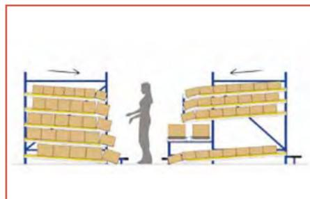
Dynamiques cartons et convoyeurs intégrés.
