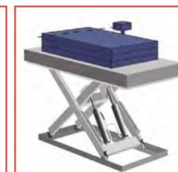
Arrêt automatique à hauteur voulue par cellule photoélectrique
