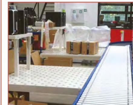
Exemple avec 6 postes de contrôle et convoyeur motorisé pour transfert vers l'expédition et mise sur palettes.
