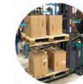
Le Gerbeur peut déplacer deux palettes simultanément, une sur les fourches, la seconde sur les longerons.
