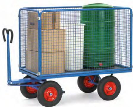
4 manchons dans les angles, essieu mobile sur rond à billes, timon en triangle avec poignée et revêtement en plastique sécurisée remontant automatiquement en position verticale. Plateau en contreplaqué avec revêtement antidérapant et hydrofuge. Roues à bandage caoutchouc dur ou gonflables, moyeu à roulement à rouleaux. Freinage automatique sur essieu avant. Conforme à la Norme Européenne EN 1757-3. Structure en tube d'acier avec treillis métallique mécano-soudé, mailles de 40 x 40 x 4 mm.
