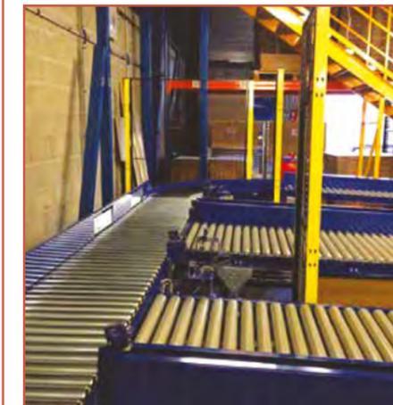
Ligne de préparation de commandes, scotcheuse automatique et lignes de tri.
